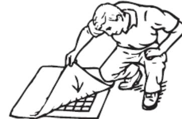
**3. Coloque sobre la alcantarilla con la parte azul hacia abajo.**
